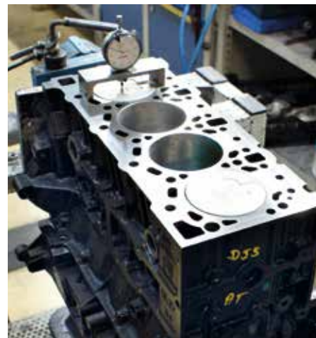
Au terme des travaux de réparation, il est nécessaire de contrôler le dépassement du piston.
